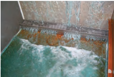
Prüfung des Rinnenkörpers mit Maschenrost 30 x 10 mm, freier Ablauf wie geständerter Belag
