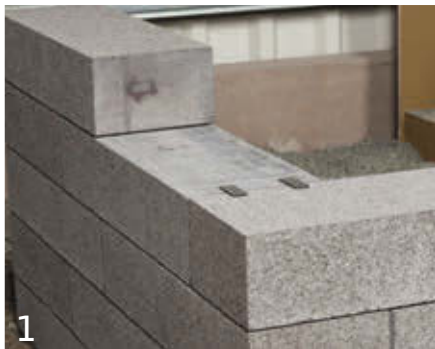
1 Alternativ zur Mauerabdeckung können Sie für den Mauerabschluss den Abdeckstein und für Ecken die Kombisteine verwenden. Kombisteine stehen in drei Formaten mit für alle Platzierungen bearbeiteten Kanten zur Verfügung. Achten Sie bei der Auswahl der jeweiligen Stein darauf Kreuzfugen zu vermeiden.
